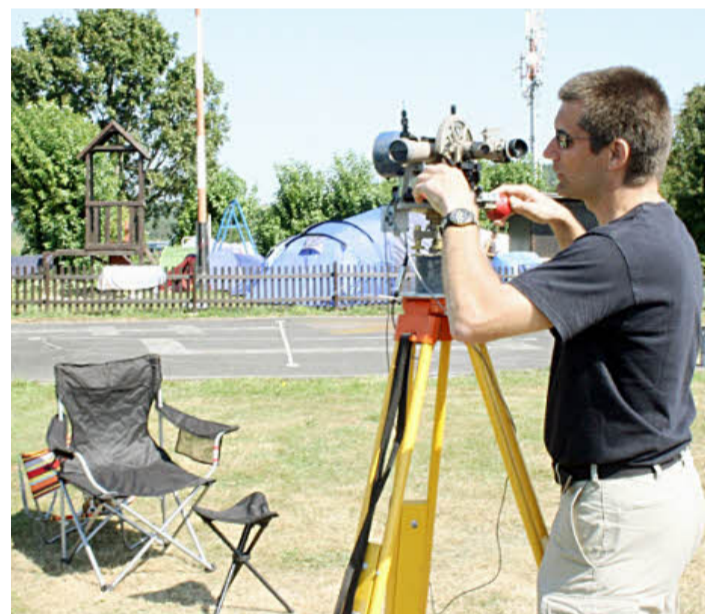
Diplom-Meteorologe Markus Garhammer positioniert einen Theodoliten. Diese Instrumente werden auch beim Vermessen eingesetzt.
